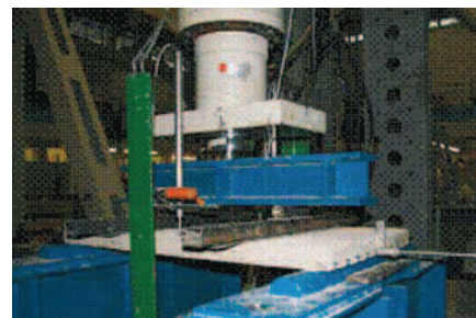
Opstilling for afprøvning af bæreevne.
